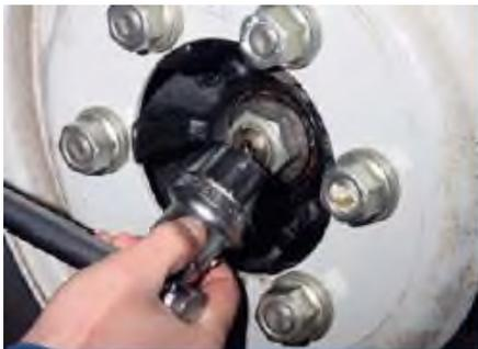
Рисунок 1.15 - Регулировка зазоров в подшипниках ступиц передних колес
