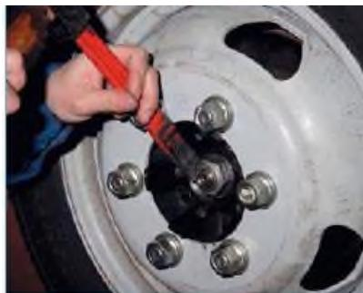
Рисунок 1.16 - Регулировка зазоров в подшипниках ступиц передних колес
